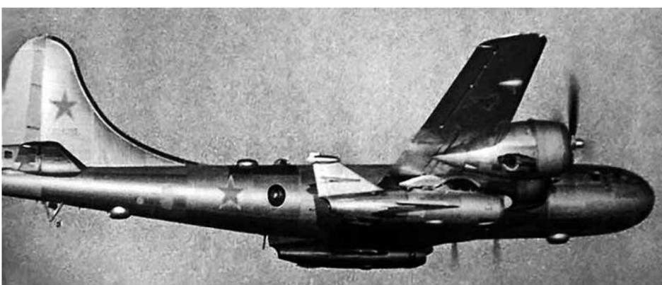
на себя, набирал высоту и разворачивался на аэродром. Чтобы аналог не попал под винты самолета-носителя, перед его отцепкой тяга двигателей Ту-4КС снижалась до минимума, и пилотируемый самолет-снаряд резко терял высоту.
