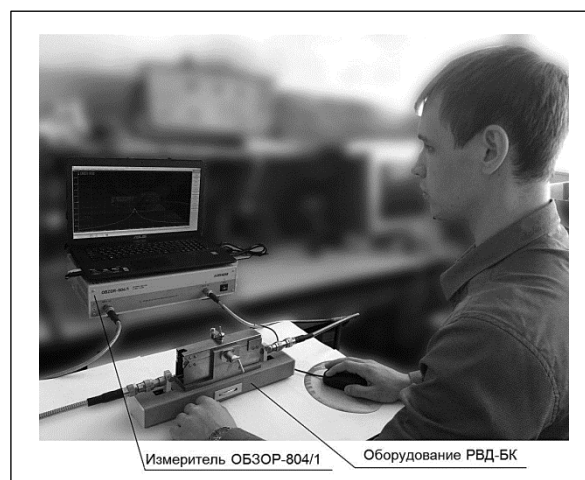
Рис. 5. Измерение диэлектрической проницаемости и тангенса угла диэлектрических потерь
