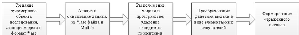
Рис. 1. Этапы моделирования отраженного сигнала
